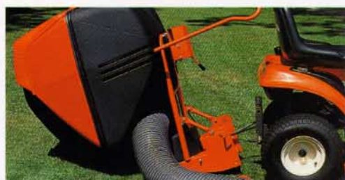
Dépose rapide et sans outillage du bac.
